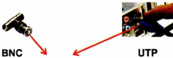
Слика 2.19. BNC конектор за коаксијални кабл и за линијску и прстен мрежу, повезивање UTP (кабл са парицама) на мрежну карту – за звјезда мрежу
