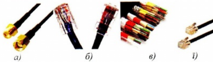
Слика 2.11. Каблови за мрежу: а) коаксијални, б) увезане парице, в) оптички каблови, г) телефонски каблови
