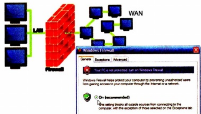
Слика 2.10. Шематски приказ заштите локалне рачунарске мреже од забрањених података веће мреже и подешавање фајервола за Windows у Control Panel-у
