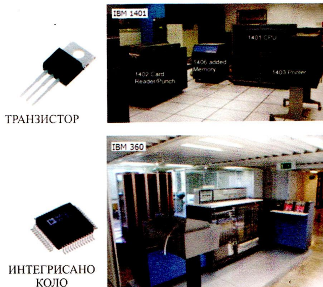
Слика 1.14. Представници 2. (IBM 1401) и 3. генерације електронских рачунара (IBM 360)
