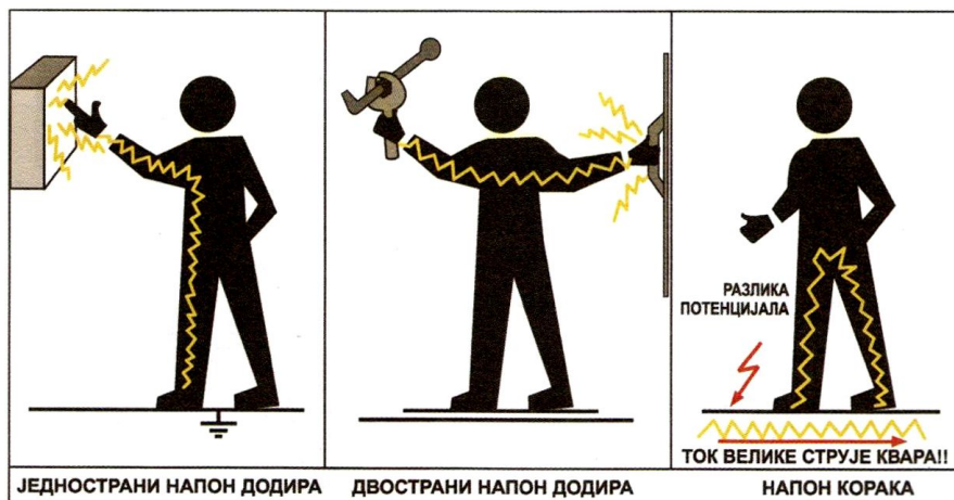
— Сл. 1.39. Напон додира и корака у случају квара уређаја —
